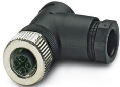
Power-Steckverbinder, 3-polig, Buchse gewinkelt M12, Kodierung: S, Schraubanschluss, Rändelmaterial: Zinkdruckguss, vernickelt, Kabelverschraubung Pg9, Leitungsaußendurchmesser 6 mm ... 8 mm, für Wechselstrom bis 16 A/630 V
