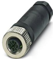
Power-Steckverbinder, 3-polig, ungeschirmt, Buchse gerade M12, Kodierung: S, Schraubanschluss, Rändelmaterial: Zinkdruckguss, vernickelt, Kabelverschraubung Pg9, Leitungsaußendurchmesser 6 mm ... 8 mm, für Wechselstrom bis 16 A/630 V
