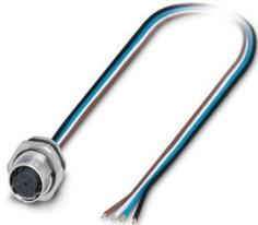
Gerätesteckverbinder Hinterwand, Universal, 4-polig, Buchse, gerade, M12-SPEEDCON, A-Kodierung, auf freies Leitungsende, Einzellitzen, Kabellänge: 0,5 m, 0,34 mm<sup>2</sup>, TPE-Litze, vergossen, dieser Artikel ist voraussichtlich ab 2026-Q1 nach RoHS II ohne Ausnahme 6c (Pb < 0,1 %) bleifrei, auf Anfrage ist eine bleifreie Alternative vorab möglich
