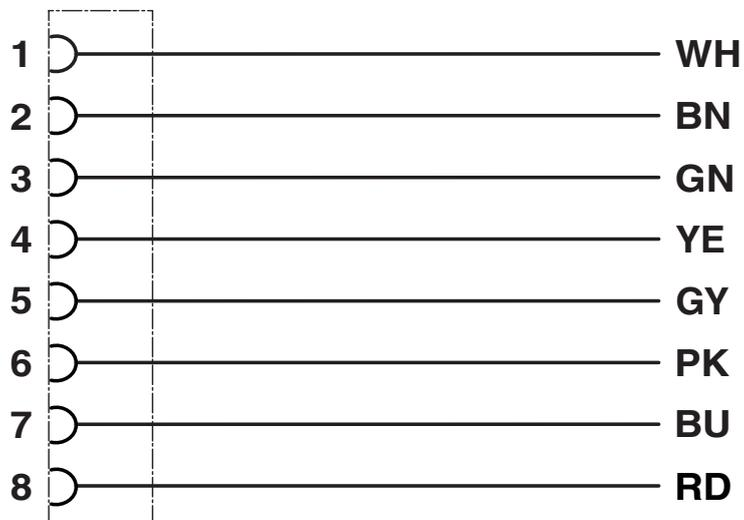
Kontaktbelegung der M12-Buchse
