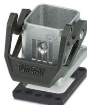
Anbaugehäuse D7, mit Längsbügel, Material: Aluminiumdruckguss, seewasserbeständig, Höhe: 25,5 mm, Kabelverschraubung: ohne, Standard
