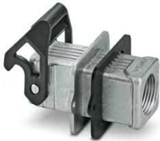
Durchführungsgehäuse D7, mit Längsbügel, Material: Aluminiumdruckguss, seewasserbeständig, Kabelabgänge: 1, gerade, 1x M20, Höhe: 60,5 mm, Kabelverschraubung: ohne, Standard
