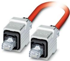
Sercos III-Kabel, geschirmt, Sternvierer, AWG 22 flexibel (7-drähtig), RAL 3020 (verkehrsrot), RJ45-Stecker/IP67 Push-Pull, Metall auf RJ45-Stecker/IP67, Metall, D-kodiert, Länge: 5 m
