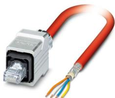
Sercos III-Kabel, geschirmt, Sternvierer, AWG 22 flexibel (7-drähtig), RAL 3020 (verkehrsrot), RJ45-Stecker/IP67 Push-Pull, Metall auf freies Leitungsende, Länge: 5 m
