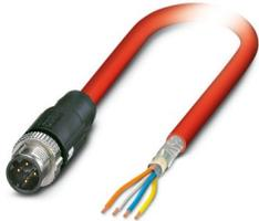
Bussystem-Kabel, Sercos CAT5 (100 MBit/s), 4-polig, PVC/PVC, verkehrsrot RAL 3020, Stecker gerade M12, Kodierung: D / IP67, auf freies Leitungsende, Kabellänge: 2 m
