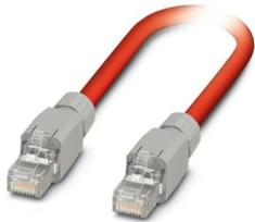
Konfektioniertes Sercos III-Kabel, geschirmt, Sternvierer, AWG 22 flexibel (7-drähtig), RAL 3020 (verkehrsrot), RJ45-Stecker/IP20, auf RJ45-Stecker/IP20, Länge: 2 m
