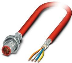
Gerätesteckverbinder Hinterwand, Sercos CAT5 (100 MBit/s) CAT5 (100 MBit/s), 4-polig, PVC halogenfrei, rot RAL 3020, geschirmt, Stift, gerade, M12-SPEEDCON, D-Kodierung, auf freies Leitungsende, Kabelanschluss, Kabellänge: 5 m, Sercos III, dieser Artikel ist voraussichtlich ab 2027-Q1 nach RoHS II ohne Ausnahme 6c (Pb < 0,1 %) bleifrei, auf Anfrage ist eine bleifreie Alternative vorab möglich
