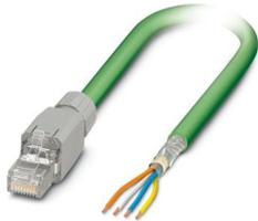
Konfektioniertes EtherCAT®-Kabel, geschirmt, Sternvierer, AWG 22 flexibel (7-drähtig), RAL 6018 (gelbgrün), RJ45-Stecker/IP20, 4-polig auf freies Leitungsende, Länge: 2 m
