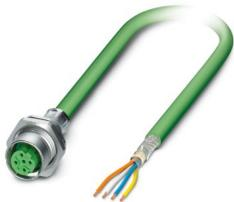
Gerätesteckverbinder Hinterwand, EtherCAT® CAT5 (100 MBit/s) CAT5 (100 MBit/s), 4-polig, PVC halogenfrei, grün RAL 6018, geschirmt, Buchse, gerade, M12-SPEEDCON, D-Kodierung, auf freies Leitungsende, Kabelanschluss, Kabellänge: 5 m, PROFINET PVC flexibel CAT5, dieser Artikel ist voraussichtlich ab 2027-Q1 nach RoHS II ohne Ausnahme 6c (Pb < 0,1 %) bleifrei, auf Anfrage ist eine bleifreie Alternative vorab möglich
