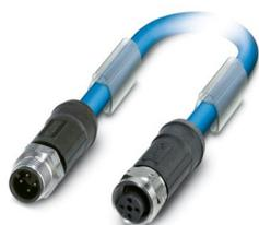
Bussystem-Kabel, PROFIBUS PA (31,25 kBit/s), 3-polig, PVC, blau RAL 5015, geschirmt, Stecker gerade M12, Kodierung: A, auf Buchse gerade M12, Kodierung: A, Kabellänge: 5 m, für Ex-Bereich mit Edelstahlrändel
