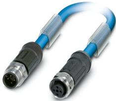
Bussystem-Kabel, PROFIBUS PA (31,25 kBit/s), 3-polig, PVC, blau RAL 5015, geschirmt, Stecker gerade M12, Kodierung: A, auf Buchse gerade M12, Kodierung: A, Kabellänge: 2 m, für Ex-Bereich mit Edelstahlrändel
