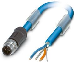
Bussystem-Kabel, PROFIBUS PA (31,25 kBit/s), 3-polig, PVC, blau RAL 5015, geschirmt, Stecker gerade M12, Kodierung: A, auf freies Leitungsende, Kabellänge: 20 m, für Ex-Bereich mit Edelstahlrändel
