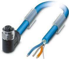
Bussystem-Kabel, PROFIBUS PA (31,25 kBit/s), 3-polig, PVC, blau RAL 5015, geschirmt, freies Leitungsende, auf Buchse gewinkelt M12, Kodierung: A, Kabellänge: 15 m, für Ex-Bereich mit Edelstahlrändel
