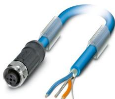
Bussystem-Kabel, PROFIBUS PA (31,25 kBit/s), 3-polig, PVC, blau RAL 5015, geschirmt, freies Leitungsende, auf Buchse gerade M12, Kodierung: A, Kabellänge: 15 m, für Ex-Bereich mit Edelstahlrändel
