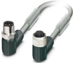
Bussystem-Kabel, CANopen®, DeviceNet™, 5-polig, PUR halogenfrei, silbergrau RAL 7001, geschirmt, Stecker gewinkelt M12 SPEEDCON, Kodierung: A, auf Buchse gewinkelt M12 SPEEDCON, Kodierung: A, Kabellänge: 0,3 m, Steckverbinder ungeschirmt
