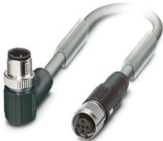
Bussystem-Kabel, CANopen®, DeviceNet™, 5-polig, PUR halogenfrei, silbergrau RAL 7001, geschirmt, Stecker gewinkelt M12 SPEEDCON, Kodierung: A, auf Buchse gerade M12 SPEEDCON, Kodierung: A, Kabellänge: 20 m, Steckverbinder ungeschirmt
