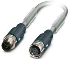
Bussystem-Kabel, CANopen®, DeviceNet™, 5-polig, PUR halogenfrei, silbergrau RAL 7001, geschirmt, Stecker gerade M12 SPEEDCON, Kodierung: A, auf Buchse gerade M12 SPEEDCON, Kodierung: A, Kabellänge: 5 m, Steckverbinder ungeschirmt
