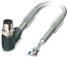
Bussystem-Kabel, CANopen®, DeviceNet™, 5-polig, PUR halogenfrei, silbergrau RAL 7001, geschirmt, Stecker gewinkelt M12 SPEEDCON, Kodierung: A, auf freies Leitungsende, Kabellänge: 15 m, Steckverbinder ungeschirmt
