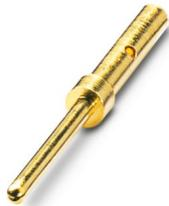
D-SUB-Crimpkontakt, Stift, gedreht, Kontaktdurchmesser: 0,76 mm, Bemessungsstrom: 3 A, Anschlussquerschnitt: 0,08 mm<sup>2</sup> ... 0,34 mm<sup>2</sup>, AWG 28...22, Material Kontakt: Metall
