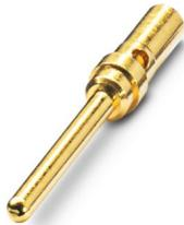
D-SUB-Crimpkontakt, Serie: HC-M-DSUB-C, Stift, gedreht, Kontaktdurchmesser: 1 mm, Bemessungsstrom: 5 A, Anschlussquerschnitt: 0,2 mm<sup>2</sup> ... 0,5 mm<sup>2</sup>, AWG 24...20, Material Kontakt: Metall
