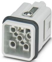
Kontakteinsatz, Polzahl: 12+PE, Baugröße: D7, Anzahl der Anschlüsse je Pol: 1, Stift, Crimpanschluss, 400 V, 12 A, 0,14 mm<sup>2</sup> ... 2,5 mm<sup>2</sup>
