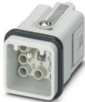
Kontakteinsatz, Polzahl: 7+PE, Baugröße: D7, Anzahl der Anschlüsse je Pol: 1, Stift, Crimpanschluss, 400 V, 12 A, 0,14 mm<sup>2</sup> ... 2,5 mm<sup>2</sup>
