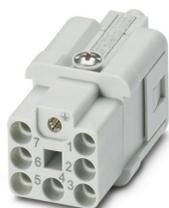
Kontakteinsatz, Polzahl: 7+PE, Baugröße: D7, Anzahl der Anschlüsse je Pol: 1, Buchse, Crimpanschluss, 400 V, 12 A, 0,14 mm<sup>2</sup> ... 2,5 mm<sup>2</sup>
