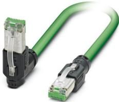
Patch-Kabel, Schutzart: IP20, Kabellänge: 0,3 m, Polzahl: 4, 100 MBit/s, Material: PA 6.6, PROFINET, 1x4xAWG22/7, SF/TQ, grün RAL 6018
