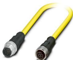
Sensor-/Aktor-Kabel, 8-polig, PVC, gelb, Stecker gerade M12, Kodierung: A, auf Buchse gerade M12, Kodierung: A, Kabellänge: 10 m
