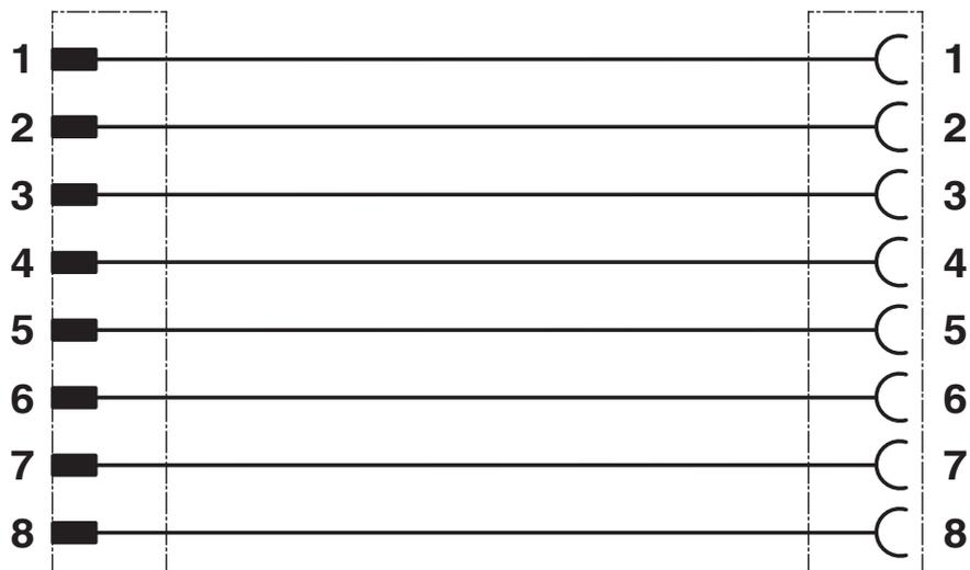
Kontaktbelegung des M12-Stecker und der M12-Buchse
