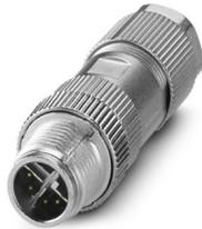
Datensteckverbinder, Ethernet CAT6<sub>A</sub> (10 GBit/s), 8-polig, geschirmt, Stecker gerade M12 SPEEDCON, Kodierung: X, Piercecon®-Schnellanschluss, Rändelmaterial: Zinkdruckguss, vernickelt, Leitungsaußendurchmesser 4 mm ... 8 mm
