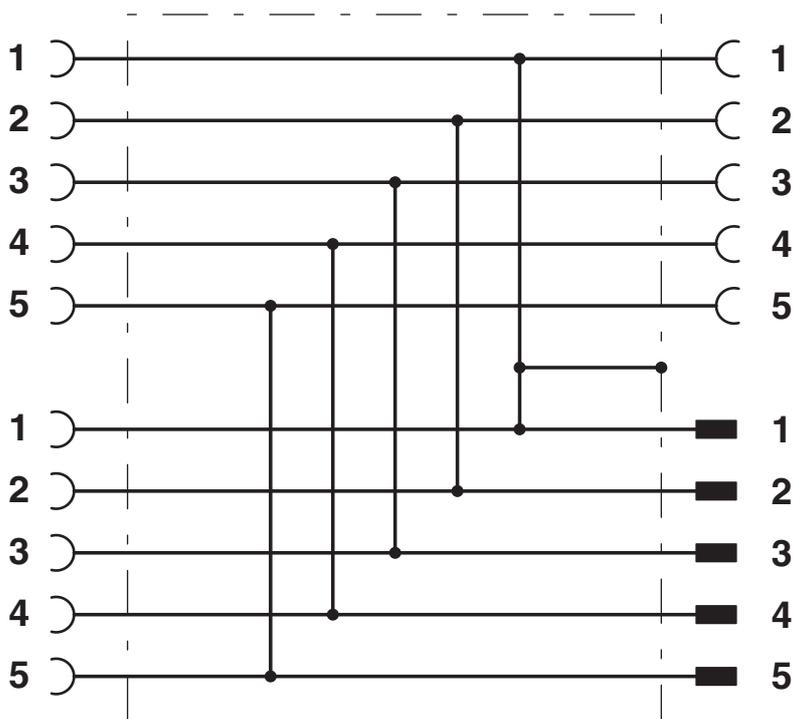
Kontaktbelegung des M12-H-Verteilers
