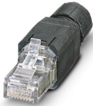
RJ45-Steckverbinder, Bauform: RJ45, Schutzart: IP20, Polzahl: 8, 1 GBit/s, CAT5 (IEC 11801:2002), Material: Kunststoff, Anschlussart: Schneidklemmanschluss, Anschlussquerschnitt: AWG 26- 23, Kabelabgang: gerade, Farbe: schwarz, Ethernet
