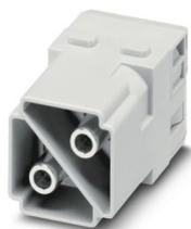
Kontakteinsatzmodul, Polzahl: 2, Leistungskontakte: 2, Steuerkontakte: 0, Stift, Axialschraubanschluss, 1000 V, 100 A, 10 mm<sup>2</sup> ... 35 mm<sup>2</sup>, Anwendung: Leistung
