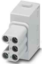
Kontakteinsatzmodul, Polzahl: 5, Leistungskontakte: 5, Steuerkontakte: 0, Buchse, Push-in-Anschluss, 400 V, 16 A, 0,14 mm<sup>2</sup> ... 2,5 mm<sup>2</sup>, Anwendung: Leistung
