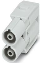
Kontakteinsatzmodul, Polzahl: 2, Leistungskontakte: 2, Steuerkontakte: 0, Stift, Axialschraubanschluss, 690 V, 70 A, 4 mm<sup>2</sup> ... 25 mm<sup>2</sup>, Anwendung: Leistung
