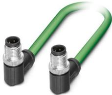
Netzkabel, PROFINET CAT5 (100 MBit/s), EtherCAT® CAT5 (100 MBit/s), 4-polig, PUR halogenfrei, grün RAL 6018, geschirmt (Advanced Shielding Technology), Stecker gewinkelt M12, Kodierung: D / IP67, auf Stecker gewinkelt M12, Kodierung: D / IP67, Kabellänge: 2 m
