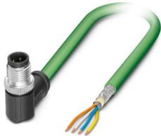
Netzwirkkabel, PROFINET CAT5 (100 MBit/s), EtherCAT® CAT5 (100 MBit/s), 4-polig, PUR halogenfrei, grün RAL 6018, geschirmt (Advanced Shielding Technology), Stecker gewinkelt M12, Kodierung: D / IP67, auf freies Leitungsende, Kabellänge: 2 m
