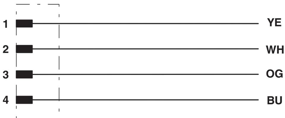
Kontaktbelegung des M12-Steckers
