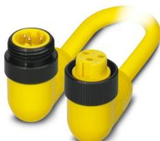
Powerleitung, 3-polig, PVC, gelb, Stecker gewinkelt 7/8"-16UNF, Kodierung: A, auf Buchse gewinkelt 7/8"-16UNF, Kabellänge: 2 m
