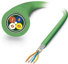
Meterware, Datenkabel, PROFINET CAT5 (100 MBit/s), EtherCAT® CAT5 (100 MBit/s), geschirmt, PUR halogenfrei, grün RAL 6018, 4-adrig (1x4xAWG22/7, SF/TQ), Farbe Einzelader: weiß, gelb, blau, orange, Kabellänge: 100 m
