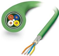
Meterware, Datenkabel, PROFINET CAT5 (100 MBit/s), EtherCAT® CAT5 (100 MBit/s), geschirmt, PUR halogenfrei, grün RAL 6018, 4-adrig (1x4xAWG22/19, S/TQ), Farbe Einzelader: weiß, gelb, blau, orange, Kabellänge: 100 m
