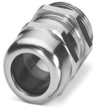
Kabelverschraubung, Material Verschraubung: Messing, vernickelt, Anwendung: Standard, Kabelaußendurchmesser 11 mm ... 17 mm, Schirmung: nein, Anschlussgewinde: M25 x 1,5, Farbe: silberfarben, mit O-Ring
