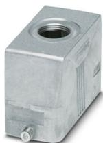
Tüllengehäuse B16, für Längsbügel, Material: Aluminiumdruckguss, seewasserbeständig, Kabelabgänge: 1, gerade, 1x M25, Höhe: 60 mm, Kabelverschraubung: ohne, Standard
