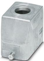
Tüllengehäuse B10, für Längsbügel, Material: Aluminiumdruckguss, seewasserbeständig, Kabelabgänge: 1, gerade, 1x M25, Höhe: 57 mm, Kabelverschraubung: ohne, Standard
