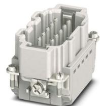
Kontakteinsatz, Polzahl: 10+PE, Baugröße: B10, Anzahl der Anschlüsse je Pol: 1, Stift, Push-in-Anschluss, 500 V, 16 A, 0,14 mm<sup>2</sup> ... 2,5 mm<sup>2</sup>, Anwendung: Leistung
