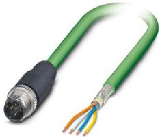
Netzwerkkabel, PROFINET CAT5 (100 MBit/s), 4-polig, PUR halogenfrei, grün RAL 6018, Stecker gerade M12, Kodierung: D / IP67, auf freies Leitungsende, Kabellänge: 2 m
