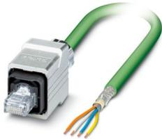
Konfektioniertes PROFINET-Kabel, CAT5e, geschirmt, Sternvierer, AWG 22 schleppkettentauglich (7-drähtig), RAL 6018 (gelbgrün), RJ45-Stecker/IP67 Push-Pull Metallgehäuse auf freies Leitungsende, Line, Länge 5 m
