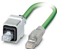
Konfektioniertes PROFINET-Kabel, CAT5e, geschirmt, Sternvierer, AWG 22 schleppkettentauglich (7-drähtig), RAL 6018 (gelbgrün), RJ45-Stecker/IP67 Push-Pull Metallgehäuse auf RJ45-Stecker/IP20, Line, Länge 5 m
