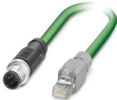
Netzwirkabel, PROFINET CAT5 (100 MBit/s), EtherCAT® CAT5 (100 MBit/s), 4-polig, PUR halogenfrei, grün RAL 6018, geschirmt (Advanced Shielding Technology), Stecker gerade M12, Kodierung: D / IP67, auf Stecker gerade RJ45 / IP20, Kabellänge: 2 m
