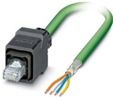
Konfektioniertes PROFINET-Kabel, CAT 5e, geschirmt, Sternvierer, AWG 22 flexibel (7-drähtig), RAL 6018 (gelbgrün), freies Leitungsende auf RJ45-Stecker/IP67 Push-Pull Kunststoffgehäuse, Line, Länge: 5 m
