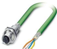
Gerätesteckverbinder Hinterwand, PROFINET CAT5, 4-polig, PVC, grün RAL 6018, Buchse, gerade, M12, D-Kodierung, auf freies Leitungsende, Kabelanschluss, Kabellänge: 2 m, 0,34 mm<sup>2</sup>, PROFINET
