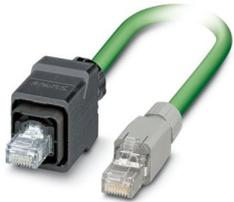
Konfektioniertes PROFINET-Kabel, CAT 5e, geschirmt, Sternvierer, AWG 22 flexibel (7-drähtig), RAL 6018 (gelbgrün), RJ45-Stecker/IP67 Push-Pull Kunststoffgehäuse auf RJ45-Stecker/IP20, grau, Line, Länge: 5 m
