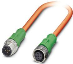
Sensor-/Aktor-Kabel, 5-polig, PUR halogenfrei, schweißperlenbeständig, orange RAL 2003, Stecker gerade M12, Kodierung: A, auf Buchse gerade M12, Kodierung: A, Kabellänge: 0,3 m, für Roboter und Schleppketten
